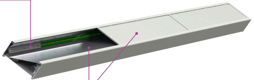
Асимметричная КСС сформирована алюминиевым отражателем и матовым рассеивателем со специальной оптической пленкой, снижающей слепящий эффект без искажения угла светораспределения
