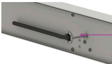
Установка в нишу стеллажа при помощи монтажных шпилек
