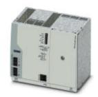
Источник бесперебойного питания 1AC/1AC/750 BA со встроенным энергоаккумулятором, свинцово-кислотный, технология VRLA, 24 DC, 3,4 A-ч для систем 230 В перем. тока.
